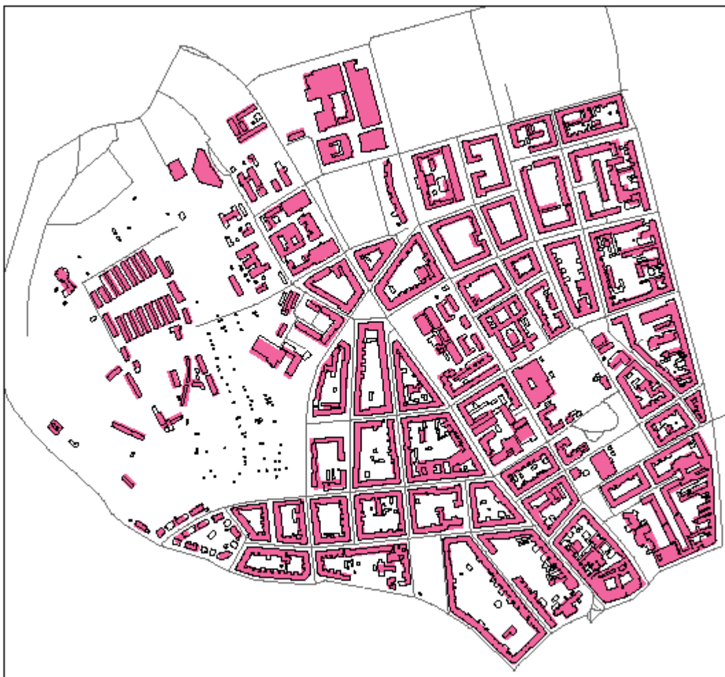
Obr. 18: Ukázka (výřez z mapy) srovnání obrysů budov původních dat 1:10000 (černě) a obrysů po generalizaci do měřítka 1:50000 (červeně). Oblast: městská část Veveří.
