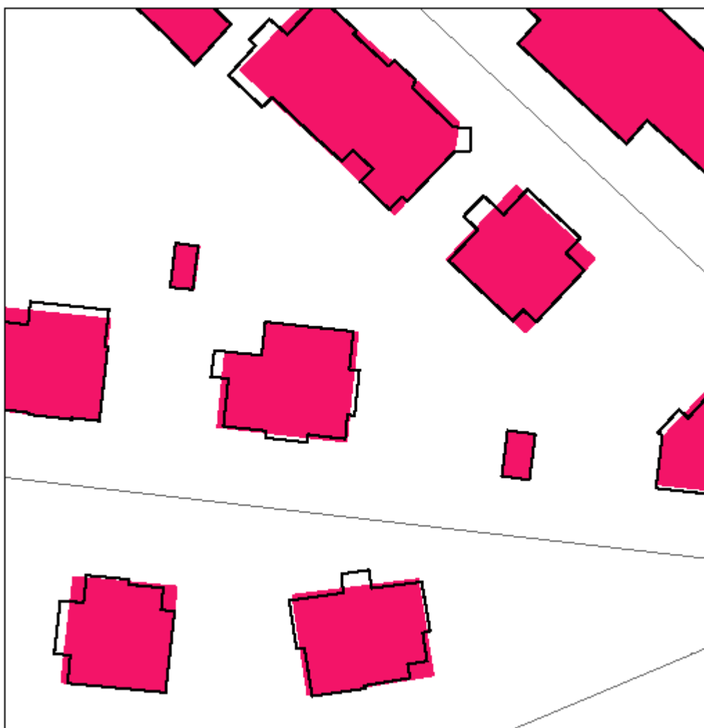
Obr. 16: Ukázka (výřez z mapy) srovnání obrysů budov původních dat 1:500 (černě) a obrysů po generalizaci do měřítka 1:10000 (červeně).
